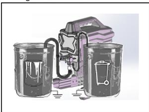
6. Entlüftungs-/Sprühventil nach unten in die PRIME-Position drehen.
