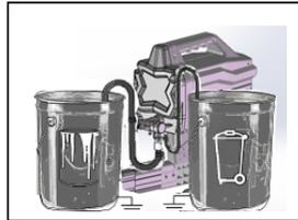
7. Den Druckregler gegen den Uhrzeigersinn auf die Einstellung Grundierung/Reinigung drehen.
