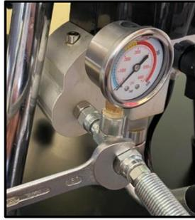
6. Füllen Sie jedes Mal bevor Sie spritzen, ca. 3-5 Tropfen Kolbenöl an der Kolbenöffnung vorne seitlich ein, um vorzeitigem Verschleiß entgegenzuwirken.
